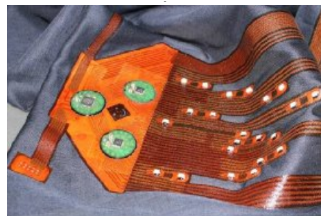
شكل "٩" تغليف وحدة التحكم مع لوحة الدوائر المرنه SCB. Vanfleteren J. (2012)
